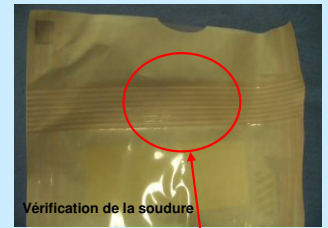
Absence de bulles et de plis, soudure continue et régulière
