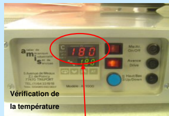
Entre 175°C et 200°C (vapeur)
